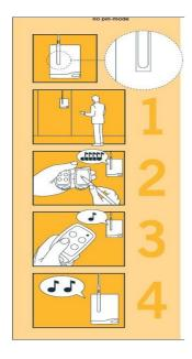
Utiliser une télécommande déjà en fonction pour programmer la nouvelle télécommande.
