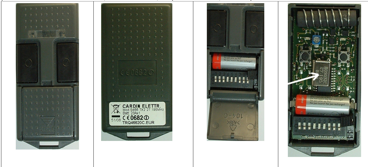
Vue de dessus : en bas le logo avec la marque CARDIN Vue de dos : Étiquette avec - la marque CARDIN - la référence S466 TX2 - la fréquence : 27,195Mhz Trappe d'accès à la pile ( pile 12V) et à la barrette de 9 mini-interrupteurs 3 positions +, 0 et - Télécommande ouverte avec visualisation de la fréquence 27, 195 Mhz gravé sur le Quartz
